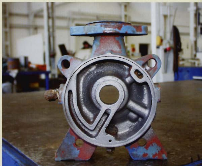
Mit dem Pumpen-Reiniger Inox-Cleaner gelingt das schneller und besser als mit dem herkömmlichen Glasperlenstrahlen.
