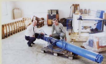
Das Reinigen von solchen großen U-Pumpen erhöht den Wirkungsgrad wieder auf die ursprünglichen Werte . Links: Reiner Weber, Geschäftsführer der ReiCo GmbH (Entwickler des Inox-Cleaners ); rechts: Gerhard Binder, zuständig für die Werksreparaturen bei Vogel-Pumpen .
